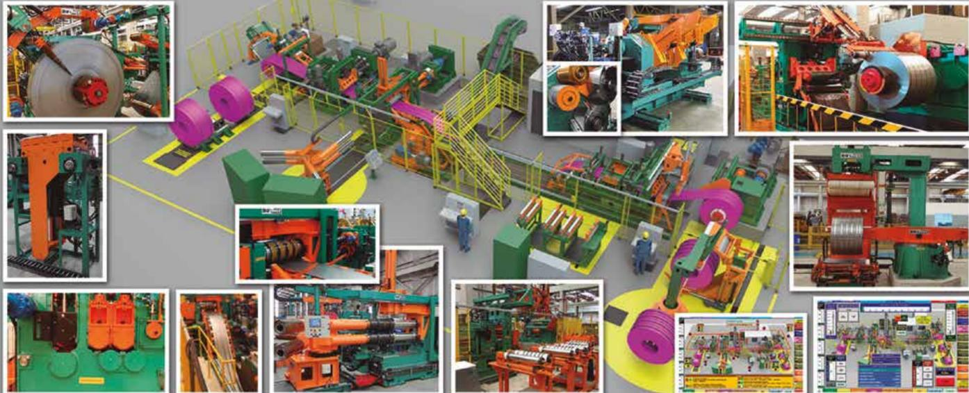
**LINHA DE CORTE LONGITUDINAL para até 6mm de espessura e aços de alta resistência (até 1600MPa e 300m/min.)**
