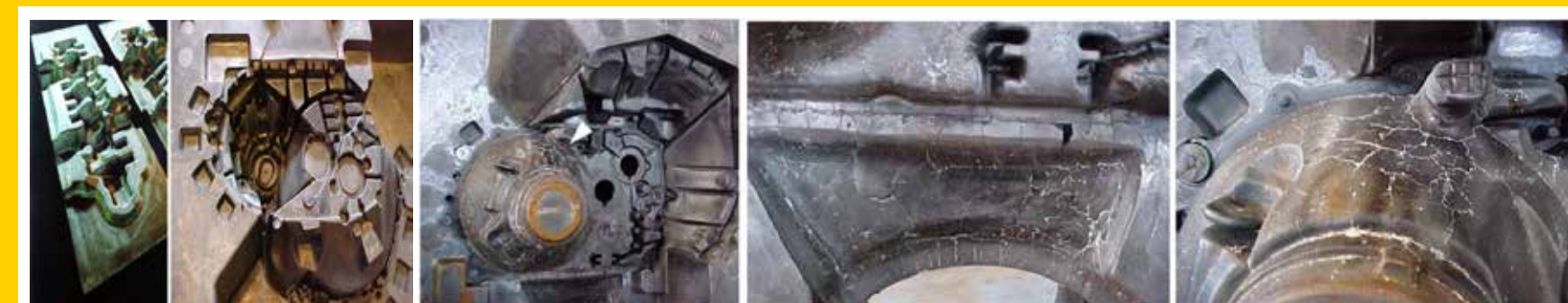
Figura 1: Matriz de injeção sob pressão. (a) matriz antes de entrar em operação; (b) matriz retirada de serviço após cerca de 100.000 ciclos, devido ao dano ocorrido por fadiga térmica e detalhes das regiões que apresentaram dano por fadiga térmica – vide regiões apresentando “malha” de trincas impregnadas com alumínio (finas linhas de cor branca).
