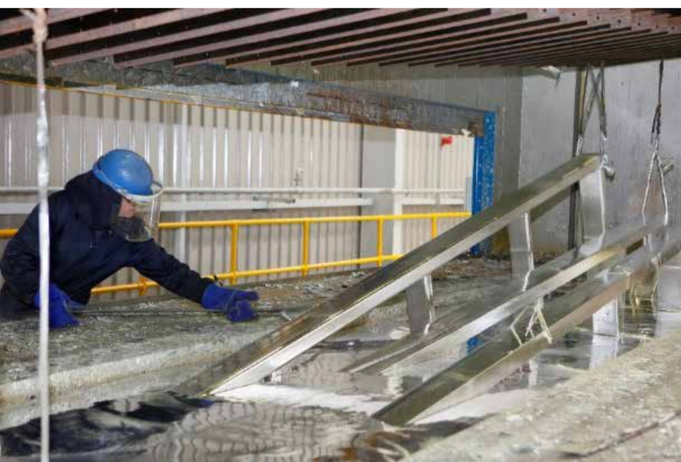
Peça (estrutura metálica) sendo imersa em um banho de Zinco.
