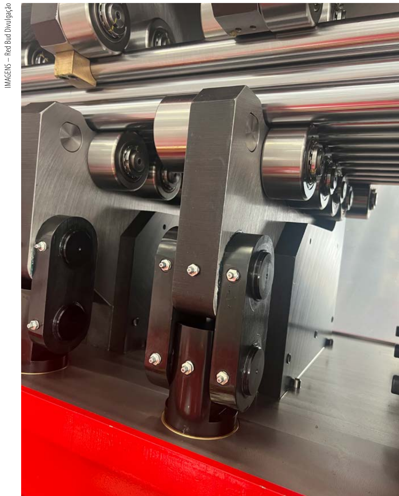
Saída do nivelador com o pino de articulação
